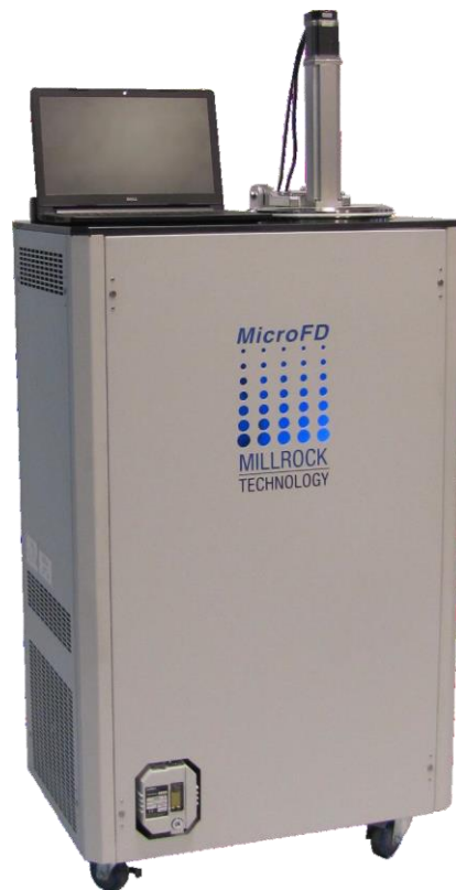
Fig.7 MicroFD®. Dimensioni 30" x 20" x 67". Peso di circa 136 kg.
