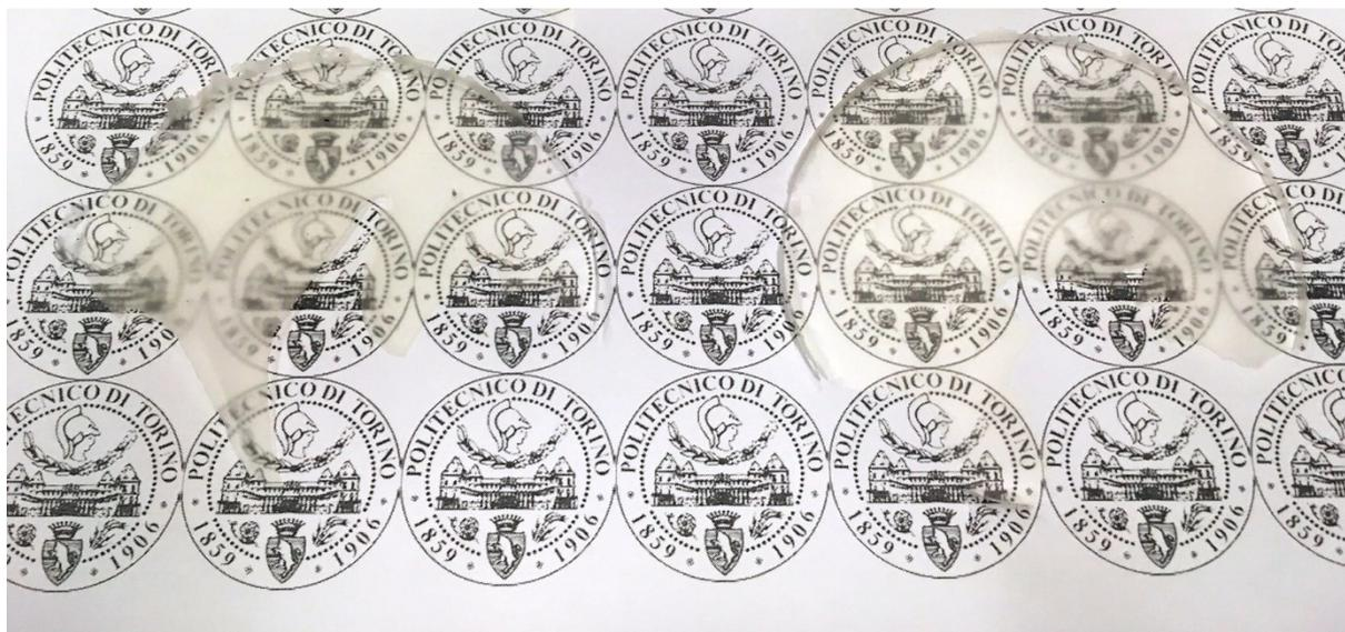
Figura 3.17 Film di amido modificato con acido itaconico 80%, MFC 20% con Darocur1173. A sinistra campione non irraggiato, a destra irraggiato per 5minuti a  $100 \text{ mW/cm}^2$
