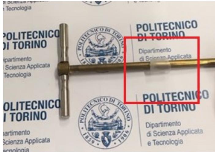
Figura 3.2 Prova di avvolgibilità del film composito (80% amido , 20% MFC) sul cilindro di diametro pari a 4mm
