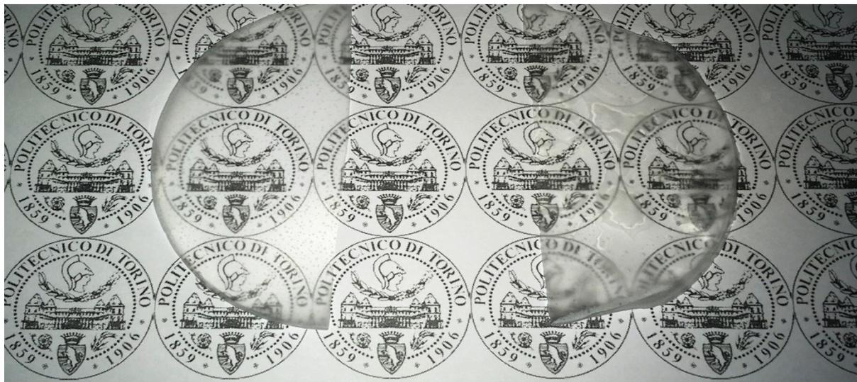
Figura 3.27 a sinistra film di amido e MEMO (80%), MFC(20%) con Darocur1173 senza irraggiamento UV, a destra dopo 5 minuti di irraggiamento a  $100\text{mW/cm}^2$
