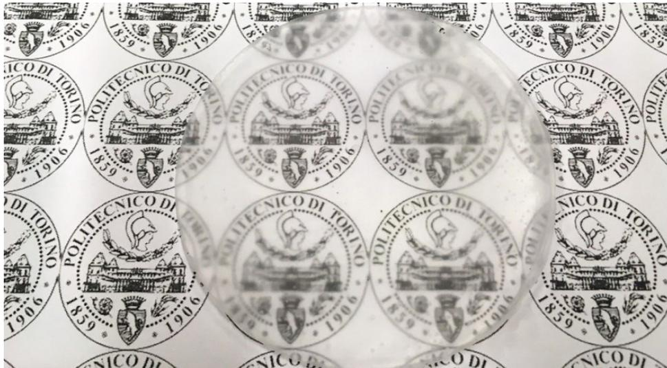
Figura 3.13 Film composito di 80% amido e acido itaconico e 20% MFC
