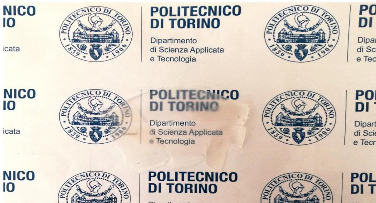
Figura 3.18 Film di amido modificato con acido itaconico 80%, MFC 20% con Darocur1173 dopo 10 minuti di irraggiamento UV a  $100\text{mW}/\text{cm}^2$
