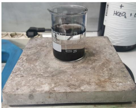
**Figura 4.3:** Lavaggio acido: catalizzatore immerso in una soluzione di acido solforico
