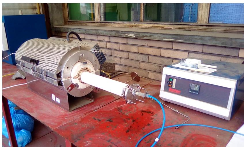
**Figura 4.2:** Forno tubolare utilizzato per i processi di pirolisi
