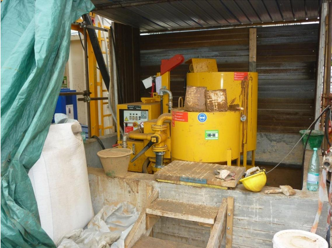
*Figura 79 – Impianto di miscelazione del fango bentonitico*
