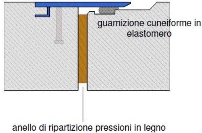
Figura 26 – Giunto a tenuta tra due sezioni contigue di tubo
