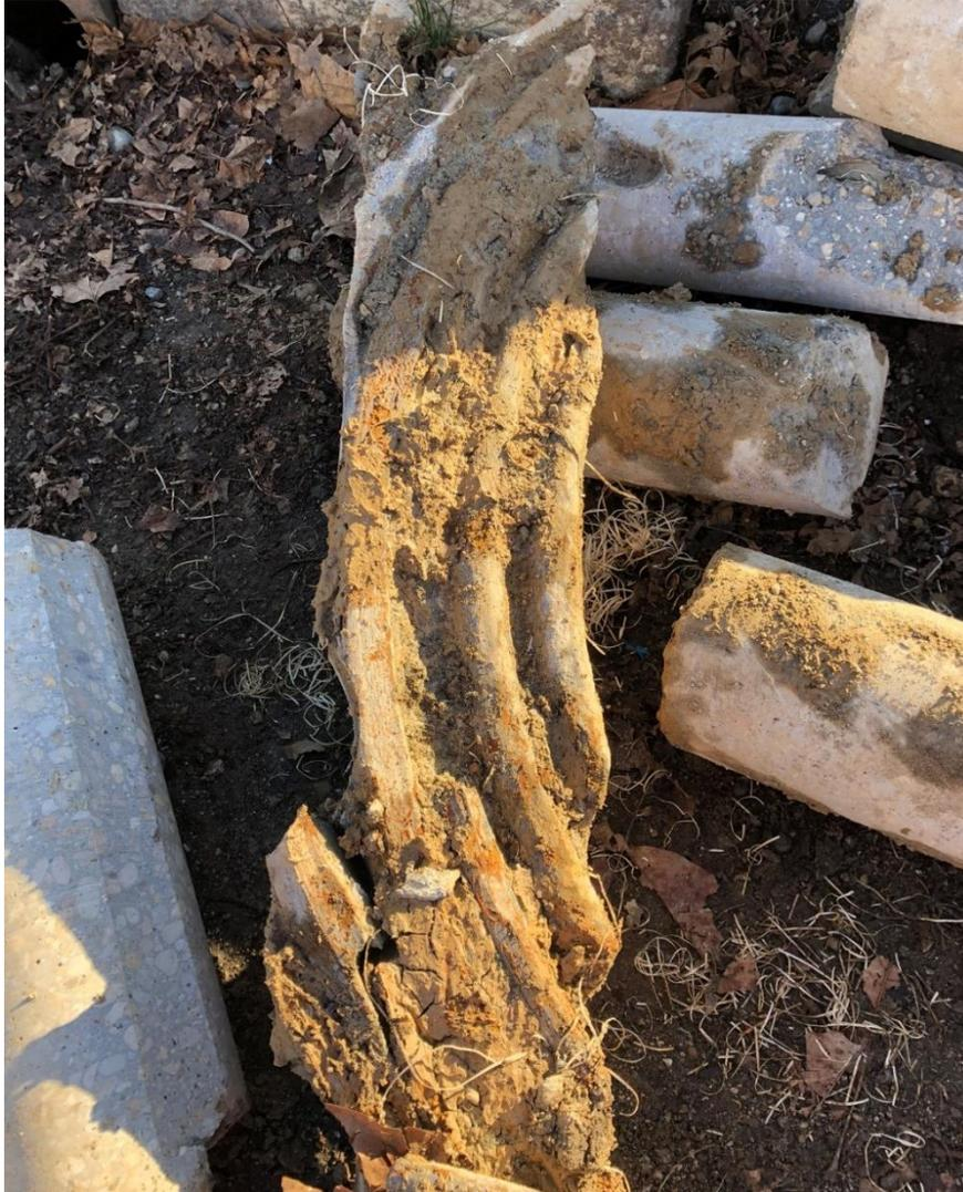
*Figura 100 – Micropalo danneggiato in cui si osservano le traiettorie di taglio degli utensili composte da cerchi concentrici, sullo sfondo alcune carote estratte per isolare il blocco di calcestruzzo armato*
