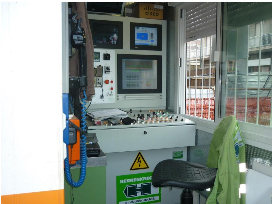
*Figura 75 – Unità di controllo computerizzata ubicata all'interno del container di guida posizionato immediatamente a ridosso del pozzo di spinta P2-15*
