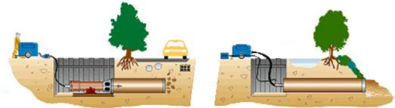
Figura 5 – Schema qualitativo di un cantiere in cui si adopera la tecnica di scavo secondo Pipe Ramming (tracto-technik.co.uk)
