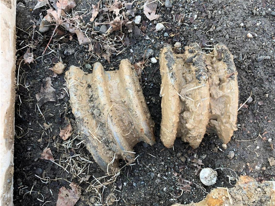
*Figura 101 – Frammenti degli utensili di scavo rotolanti danneggiati nel tentativo di penetrare il micropalo*
