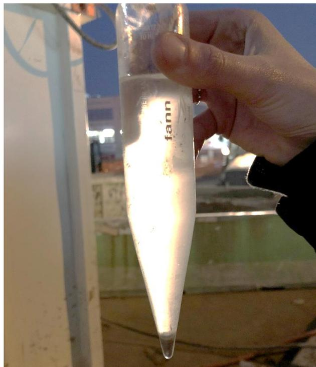
Figura 108 – Misurazione del contenuto in sabbia del fango bentonitico con provetta graduata in vetro
