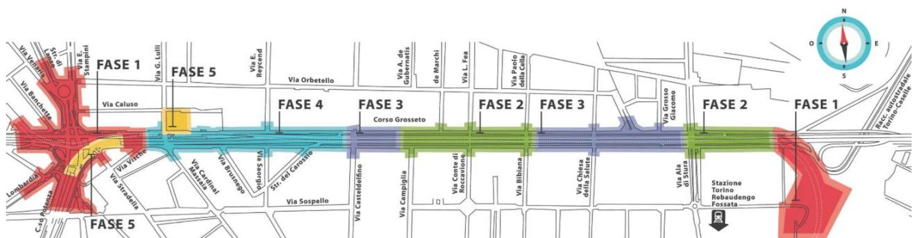
Figura 49 – Individuazione delle macrofasi su corso Grosseto con cui verrà realizzata l'opera di collegamento ferroviario della linea Torino – Ceres con il Passante ferroviario di Torino (S.C.R. Piemonte S.p.A., Nuovo collegamento ferroviario Torino – Ceres)
