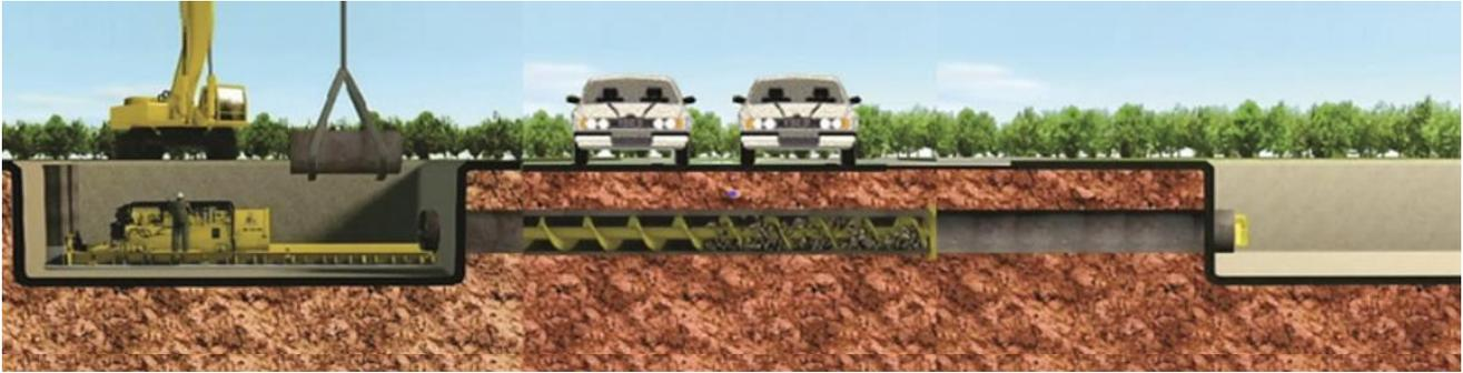
*Figura 8 – Rappresentazione qualitativa della tecnica di scavo con pressotrivella (cognigni.net)*
