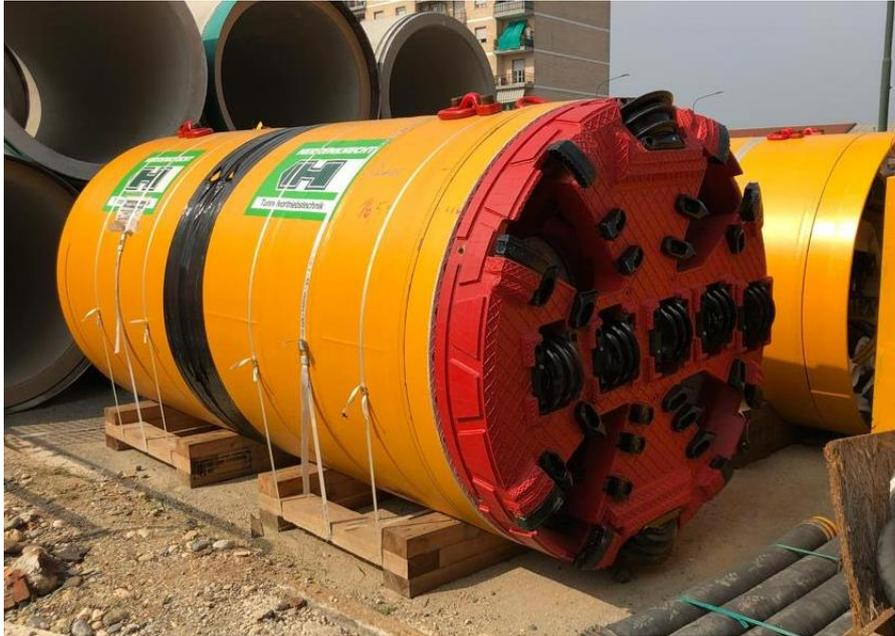
*Figura 67 – Testa fresante di scavo installata sul microtunneller*
