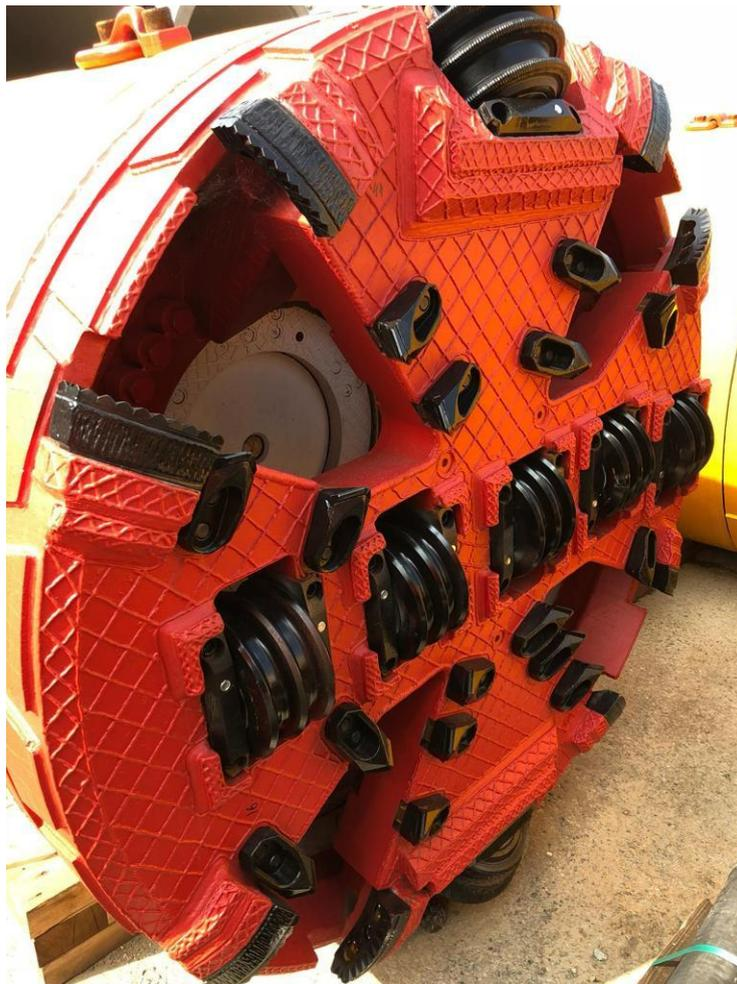
*Figura 68 – Particolare degli utensili di scavo installati: utensili striscianti e utensili rotolanti in grado di assicurare la copertura della sezione di scavo. Si nota la presenza del frantoio rotante di forma conica posto a ridosso della testa fresante*
