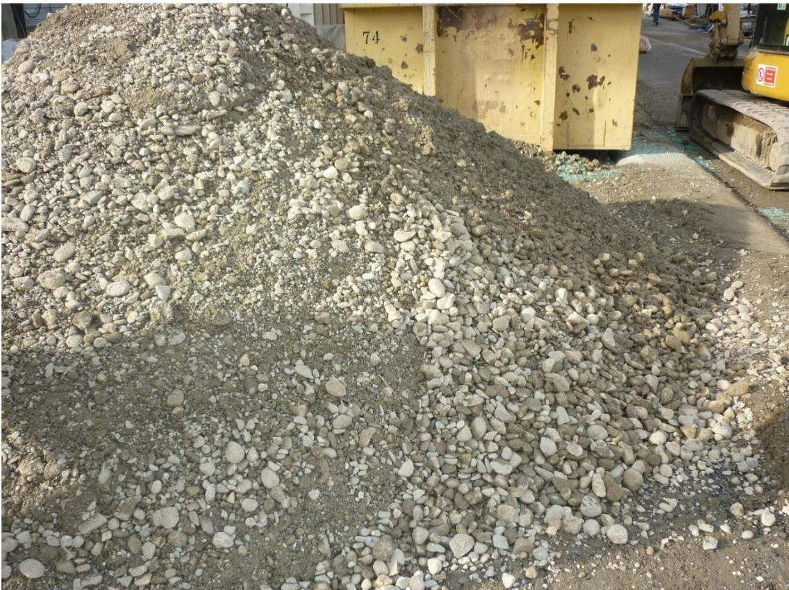
Figura 102 – Materiale di scavo dorsale n°15 prodotto dall'impianto di trattamento fanghi
