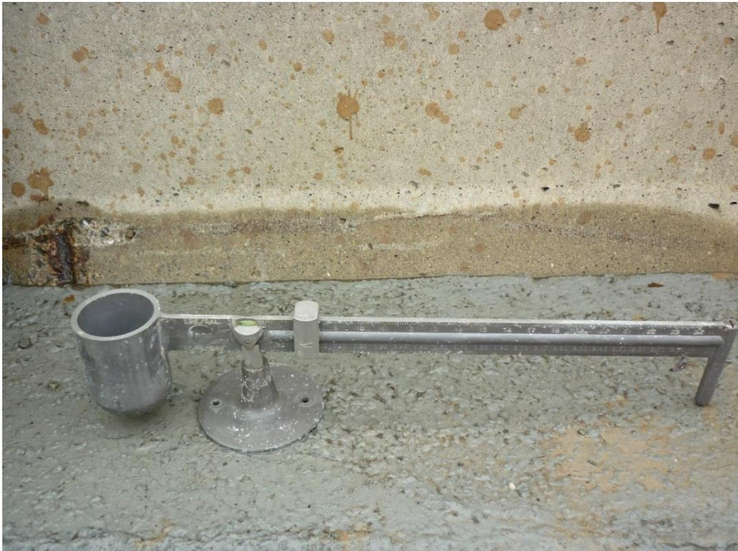
Figura 106 – Bilancia graduata con livelletta a bolla impiegata per la misurazione del peso specifico del fango bentonitico
