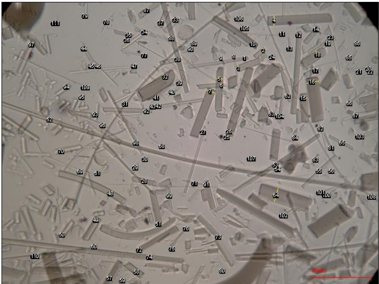
Figura 32 Misura dei diametri su ImageJ per foto scattata al MOCF ( Campione 10)
