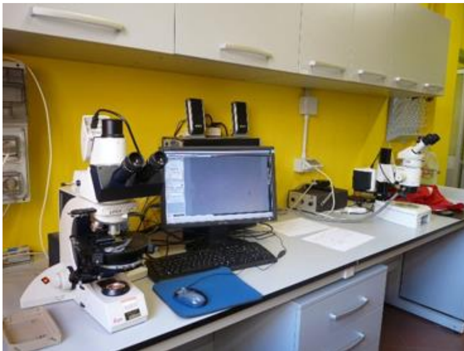
Figura 20 Microscopio ottico a contrasto di fase
