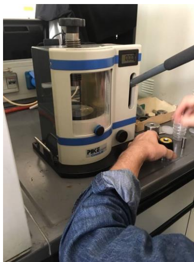
Figura 22 Pressa a 10 tonnellate per la rottura trasversale delle FAV
