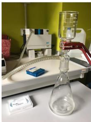
Figura 26 Sistema di filtrazione a vuoto
