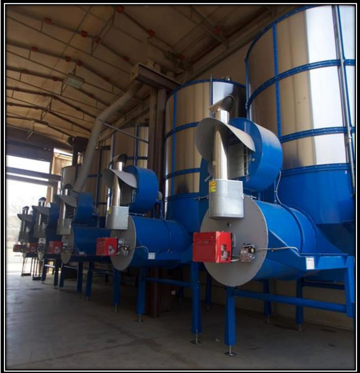
**Figura 4.3** Batteria di macchine essiccatrici, di proprietà Destefanis & Novero
