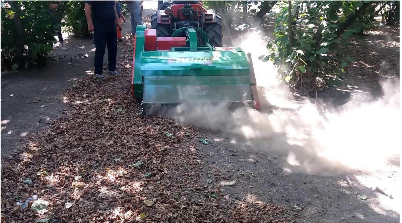
**Figura 2.2** Raccolta meccanica delle nocciole
